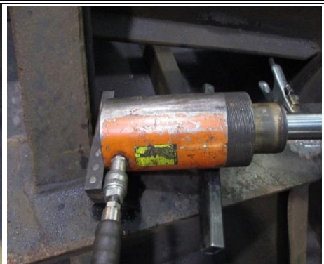
Foto 3: tijdelijk gelaste ondersteuning voor perscilinder
