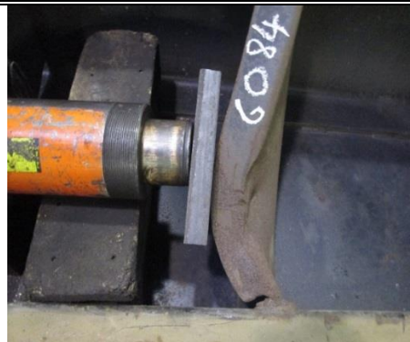
Foto 2: uitdeuken met perscilinder
