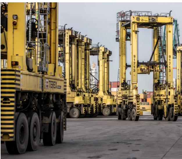
Straddle carrier, een machine om op de terminal containers te transporteren.
