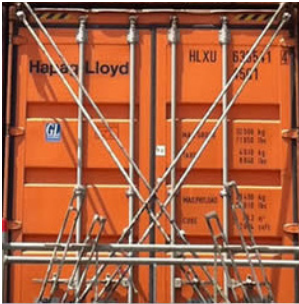
Lashingbars en tendeurs zetten containers vast op het schip.
